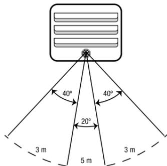
Distancia de detección del sensor de movimiento: 3 a 5 m
